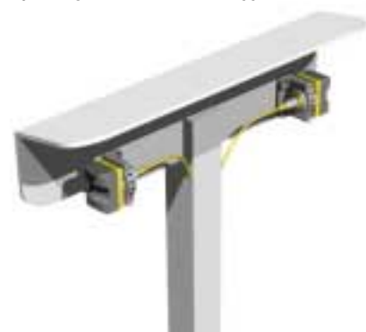
Figuur 4. Monteer de STB knoppen zodanig dat ze niet kunnen worden overbrugd of onbedoeld kunnen worden geactiveerd
