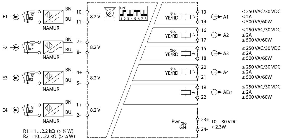
Fig. 7: Wiring diagram IM18-DI03-4S-5R
