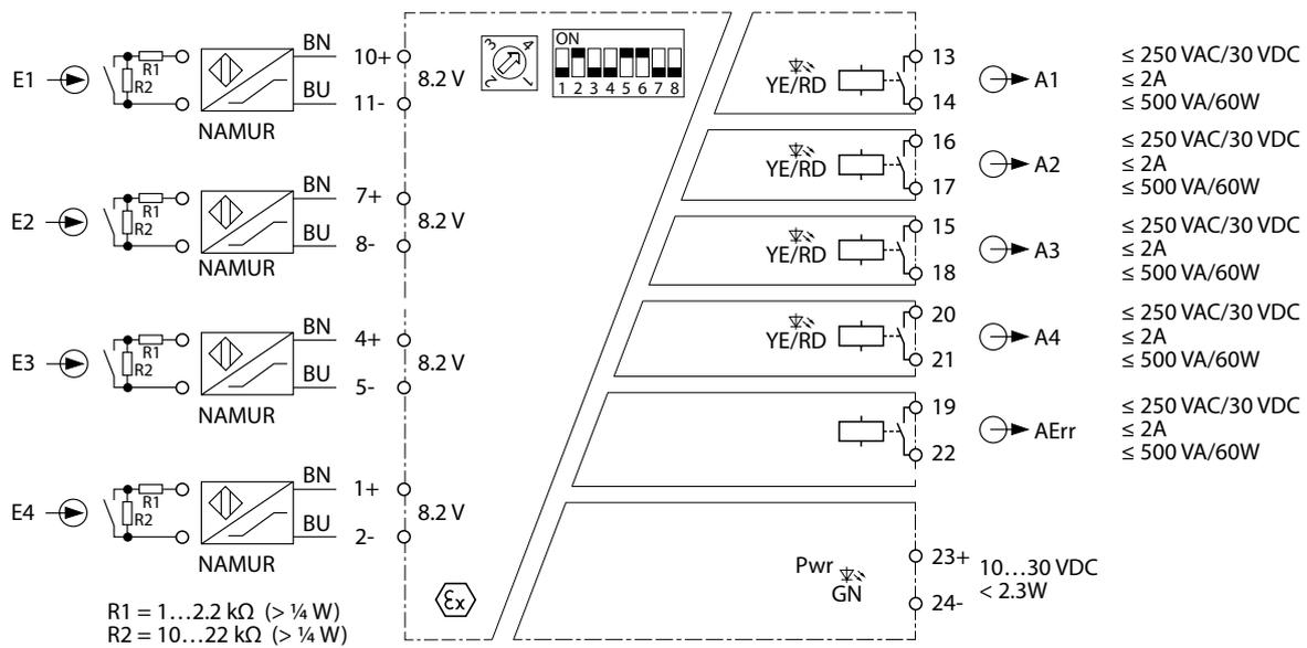
Fig. 6: Wiring diagram IMX18-DI03-4S-5R
