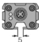
Auf der Sensorrückseite befindet sich eine Führungsnut, in die Nutsteine zur Montage verwendet werden können.
