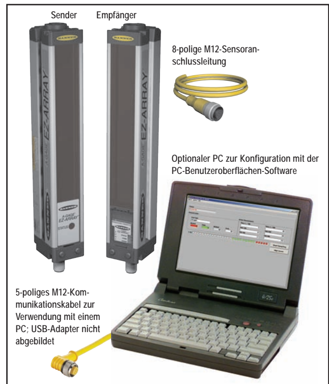
Abbildung 1-2. Systemkomponenten des A-GAGE EZ-ARRAY
