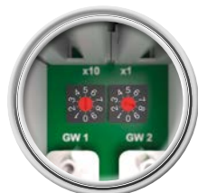
Wahl der PROFIBUS-DP-Busadresse über Drehkodierschalter
