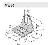
6945005 用于圆柱螺纹传感器的安装托架;材 料:不锈钢 A2 1.4301 (AISI 304)
