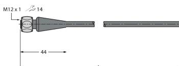
连接线缆, M12母头接插件(直式, 5针), 不锈钢联接螺母, 线缆长度 2 m, 护套材质TPE, 灰色; 适用温度范围-40...+105 °C
