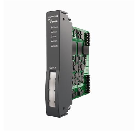
网关GDP-N用于将excom® 系统连接到 PROFIBUS-DP系统中。可使用光纤或铜芯电缆与PROFIBUS-DP建立连接。当使用光纤用于数据传输，需要使用一对光纤连接铜介质 PROFIBUS网络。
