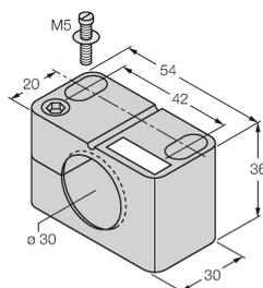
Befestigungsschelle für Gewinderohrsensoren, mit Festanschlag; Werkstoff: PA6
