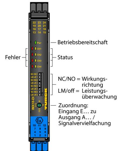
Die Trennschaltverstärker IMX18-DI03-... sind mit eigensicheren Eingangskreisen ausgestattet und übertragen binäre Signale aus dem explosionsgefährdeten Bereich in den sicheren Bereich. An die Geräte können Sensoren nach EN 60947-5-6 (NAMUR) oder potenzialfreie Kontaktgeber angeschlossen werden. Die Geräte sind auch für den Betrieb in Zone 2 geeignet.
