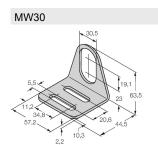
6945005 Befestigungswinkel für Gewinderohrsensoren; Werkstoff: Edelstahl A2 1.4301 (AISI 304)
