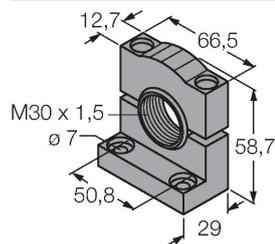
Montagehalterung, PBT-schwarz, für Sensoren mit 30-mm-Gewinde, ausrichtbar
