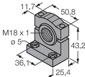
Montagehalterung, PBT-schwarz, für Sensoren mit 18-mm-Gewinde, ausrichtbar
