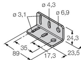
Montagewinkel, Edelstahl, für Bauform MINI-BEAM NAMUR
