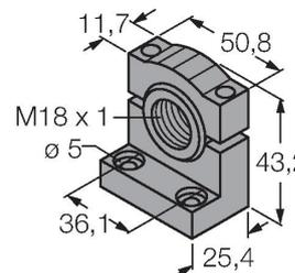
Montagehalterung, PBT-schwarz, für Sensoren mit 18-mm-Gewinde, ausrichtbar
