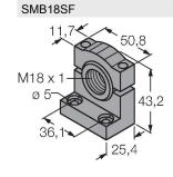
3052519 Montagehalterung, PBT-schwarz, für Sensoren mit 18-mm-Gewinde, ausrichtbar
