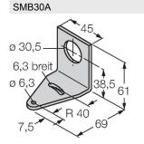
3032723 Montagewinkel, rechtwinklig, Edelstahl, für Sensoren mit 30mm Gewinde
