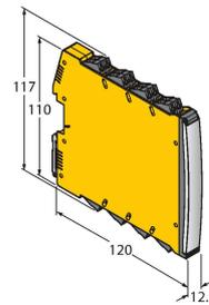
Ventil-Steuerbaustein; zweikanalig; SIL 2 gemäß IEC 61508; Ex-Ausführung; Überwachung auf Drahtbruch und Kurzschluss; abziehbare Schraubklemmen; 12,5 mm Breite; 24VDC Versorgungsspannung
