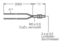
Kunststoff-Lichtwellenleiter, Betriebsart: Lichttaster, Gewindehülse M3 x 0,75 mm, konfektionierbarer Leiter ohne Endstück, Außenmantel aus Polyethylen, Umgebungstemperatur -30 °C...+70 °C
