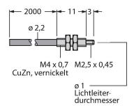
Kunststoff-Lichtwellenleiter, Betriebsart: Lichtschranke, Gewindehülse M3 x 0.5, konfektionierbarer Leiter ohne Endstück, Außenmantel aus Polyethylen, Umgebungstemperatur -30 °C...+70 °C
