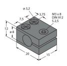
Befestigungsschelle für Gewinderohrsensoren; Werkstoff Montageblock: Aluminium, eloxiert
