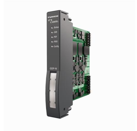
Das Gateway GDP-N dient zur Anbindung des *excom*®-Systems an PROFIBUS-DP-Netzwerke. Zum Anschluss an den PROFIBUS können entweder Lichtwellenleiter oder Kupferleitungen verwendet werden. Bei Verwendung von Lichtwellenleitern muss für den Datenaustausch zwischen drahtgebundenem und optischem PROFIBUS ein LWL-Kopplerpaar eingesetzt werden.
