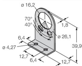
Angulo de montaje, acero galvanizado, para el modelo LX, kit compuesto por 2 pzs., no incluidas en el volumen de suministro
