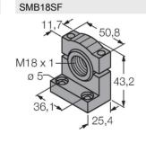
3052519 soporte de montaje, PBT negro, para sensores con rosca de 18mm, orientable
