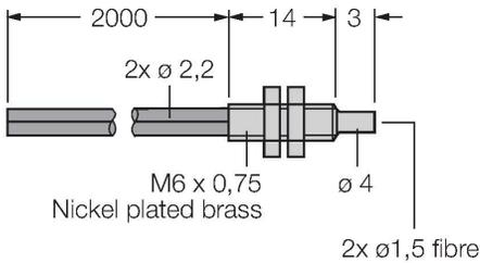
fibra óptica de material sintético, modo de detección: sensor fotoeléctrico, casquillo roscado M6 x 0,75 mm, conductor confeccionable sin pieza terminal, funda exterior de polietileno, temperatura ambiente -30 °C...+70 °C
