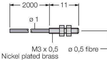
fibra óptica de plástico, modo de detección: barrera óptica, casquillo roscado M3 x 0,5, conductor confeccionable sin pieza terminal, funda exterior de polietileno, temperatura ambiente de -30 °C...+70 °C
