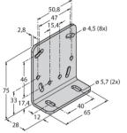
Soporte de montaje, en ángulo recto, acero inoxidable, para montaje lateral para sensores de la serie LE250/550
