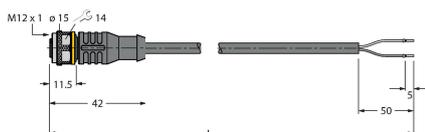
Cable de conexión, conector hembra M12, recto, de 2 polos, longitud del cable: 2 m; material de revestimiento: PVC, azul; aprobación cULus
