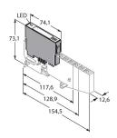
4 entradas digitales conforme a la norma EN 60947-5-6. Para sensores NAMUR, contactos sin tensión o sensores DC uprox+ de dos hilos.
