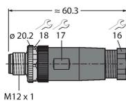
Conector macho cableable en terreno, M12 x 1, recto, 8 patillas, conexión terminal roscada, pasacables de 6,0 a 8,0 mm, sección transversal principal/capacidad del terminal de 0,14 a 0,50 mm<sup>2</sup>, carcasa de plástico, tornillo de retención de metal
