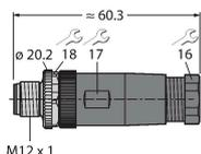
Conector macho cableable en terreno, M12 x 1, recto, 8 patillas, conexión terminal roscada, pasacables de 6,0 a 8,0 mm, sección transversal principal/capacidad del terminal de 0,14 a 0,50 mm<sup>2</sup>, carcasa de plástico, tornillo de retención de metal
