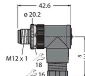
Conector macho cableable en terreno, M12 x 1, acodado, 8 patillas, conexión terminal roscada, pasacables de 6,0 a 8,0 mm, sección transversal principal/capacidad del terminal de 0,14 a 0,50 mm<sup>2</sup>, carcasa de plástico, tornillo de retención de metal
