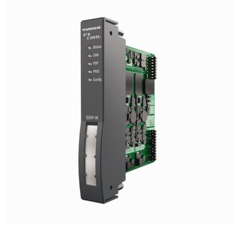
El gateway GDP-N sirve para conectar el sistema *excom*® a redes PROFIBUS-DP. Para conectar al PROFIBUS-DP pueden emplearse bien cables de fibra óptica o bien cables de cobre. Con los cables de fibra óptica es necesario, para permitir el intercambio de datos, instalar un par acoplador LWL entre el PROFIBUS alámbrico y el óptico.
