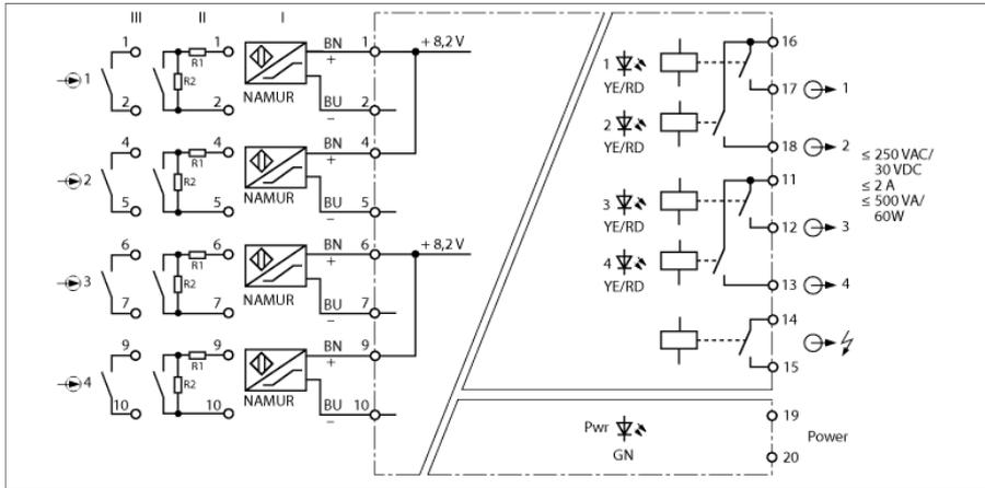
En el amplificador separador de cuatro canales tipo IM1-451-R se pueden conectar sensores conforme a la norma EN 60947-5-6 (NAMUR) o conyuntores sin potencial.
