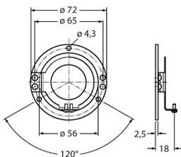
accouplement stator en acier inoxydable pour codeur à arbre creux, diamètre primitif de référence 65 mm, pour les applications standard à jeu axial et radial avec dynamique élevée
