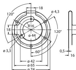
accouplement stator en acier inoxydable pour codeur à arbre creux, diamètre primitif de référence 65 mm, pour les applications à jeu axial et radial avec dynamique élevée
