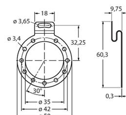
tôle de fixation en acier inoxydable pour codeur à arbre creux, diamètre primitif de référence 64,5 mm, pour les applications à jeu axial et radial avec dynamique basse
