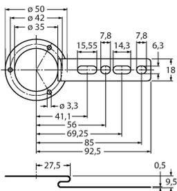
tôle de fixation en acier inoxydable pour codeur à arbre creux, diamètre primitif de référence 80...170 mm, pour les applications à jeu axial et radial avec dynamique basse
