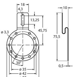
Tôle de fixation en acier inoxydable pour codeur à arbre creux, diamètre primitif de référence variable 65...91,5 mm, pour les applications à jeu axial et radial avec des rotations constantes
