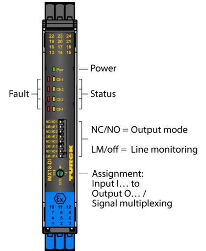
Les amplificateurs-séparateurs de commutation IMX18-DI03-... sont équipés de circuits d'entrée à sécurité intrinsèque et transmettent les signaux binaires depuis la zone présentant un risque d'explosion jusqu'à la zone sécurisée. Des détecteurs suivant EN 60947-5-6 (NAMUR) ou des contacteurs libres de potentiel peuvent être raccordés à l'appareil. Les appareils sont aussi adaptés à un fonctionnement en zone 2.
