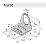
6945005 Équerre de fixation pour détecteurs à tube fileté ; matériau : acier inoxydable A2 1.4301 (AISI 304)
