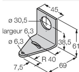
équerre de montage, coudée, acier inoxydable, pour les détecteurs à filetage 30mm
