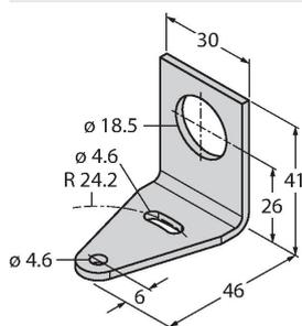
bride de fixation, coudée, acier inoxydable, pour les détecteurs à filetage de 18 mm
