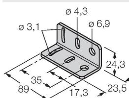
équerre de montage, acier inoxydable, pour le format MINI-BEAM NAMUR
