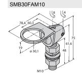
3011185 équerre de montage, acier inoxydable, pour filetage 30 mm, filetage M10 x 1,5
