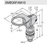
équerre de montage, acier inoxydable, pour filetage 30 mm, filetage M10 x 1,5
