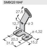
3067467 équerre de montage, acier inoxydable, pour filetage 18 mm
