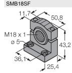
3052519 bride de fixation, noir PBT, pour les détecteurs à filetage 18 mm, orientable
