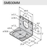
bride de fixation, à angle droit, acier inoxydable, pour les détecteurs avec filetage 30 mm, trous de forage larges pour un alignement précis
