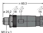
Connecteur mâle confectionnable, M12 x 1, droit, 8 pôles, raccordement par borne à vis, diamètre de ligne 6,0 à 8,0 mm, section conducteur/section raccordable 0,14 à 0,50 mm<sup>2</sup>, boîtier plastique, vis de montage métallique
