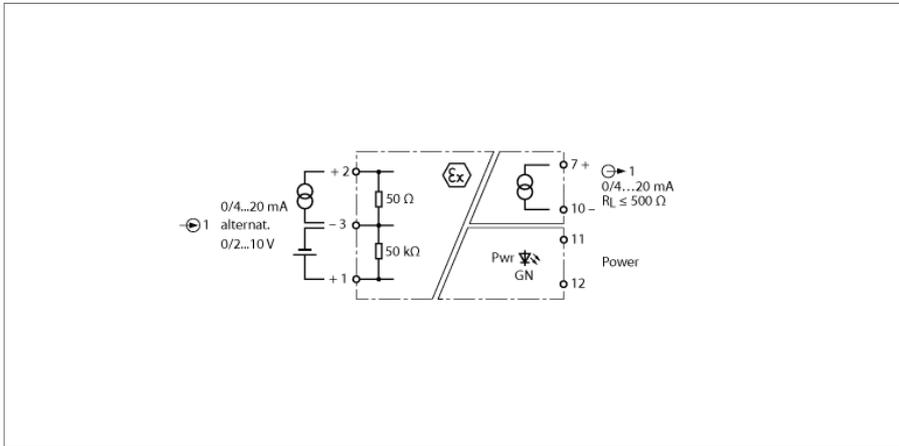
Les signaux de tension ou de courant actifs normalisés sont séparés galvaniquement par le séparateur de signaux à deux canaux IM31-11EX-I et ensuite transmis de la zone Ex à la zone non Ex.
