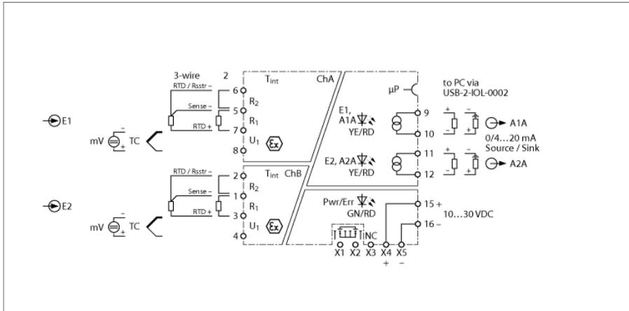
L'amplificateur de mesure de température à 2 canaux IMX12-TI02-2TCURTDR-2I-CPR/24VDC dispose d'entrées pour: des thermocouples suivant CEI 60584, DIN 43710, GOST R 8.585-2001, des tensions faibles (-150...+150 mV), RTD suivant CEI 60751, DIN 43760, GOST 6651-94 (2, 3 fils) ainsi que des résistances 0...5 kΩ (2, 3 fils) L'appareil peut être alimenté par un power-bridge, qui transmet aussi une alarme collective.
