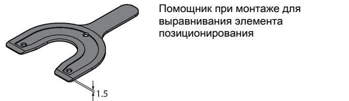
Помощник при монтаже для выравнивания элемента позиционирования
