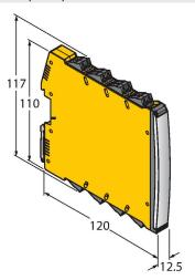
Изолирующий переключающий усилитель, 2-канальный; SIL2 по IEC 61508; Взрывозащищенная версия; 2 транзисторных выхода; вход для сигналов NAMUR; Вкл/ Выкл мониторинга линии на обрыв и КЗ; переключатель режима НО/ НЗ; дублирование сигнала; съемные винтовые клеммы; ширина 12,5 мм; источник питания 24 В пост. тока
