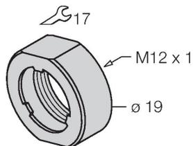
Гайка для защиты от ударов для резьбовых приборов M12x1; материал: Нерж. сталь A2 1.4305 (AISI 303)
