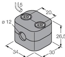
Монтажный зажим для цилиндрических гладких и резьбовых датчиков; материал: Полипропилен
