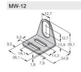
6945003 Монтажный кронштейн для цилиндрических резьбовых датчиков; материал: Нержавеющая сталь A2 1.4301 (AISI 304)
