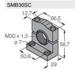
Монтажный зажим, РВТ черн., для датчиков с резьбой 30 мм, поворотный
