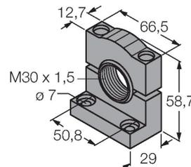
Монтажный зажим, PBT черн., для датчиков с резьбой 30 мм, поворотный
