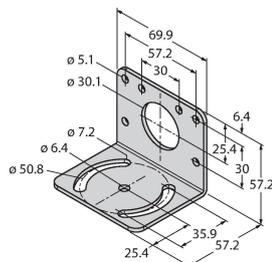
Монтажный зажим, нерж. сталь, для датчиков с резьбой 30 мм
