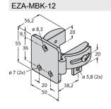
Монтажный зажим, черный, стальной, для EZ-ARRAY и EZ-SCREEN стандартных и подключаемых в каскад, с разрешением 14 и 30 мм
